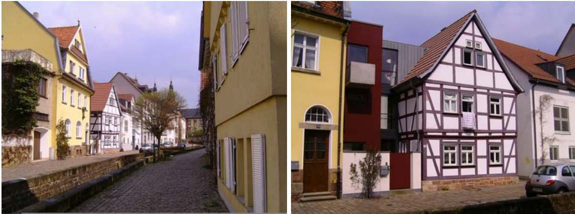
Bsp.14: Ergänzungen sollen sich mit dem Vorgefundenen auseinandersetzen und darauf reagieren – in Farbe, Material und Proportionen. Das abgebildete Beispiel bedient sich für den neu errichteten Anbau eigener, moderner Formen. Die Fachwerkkonstruktion und das Satteldach des sanierten Altbaus zu kopieren, wäre für die Erweiterung nicht zeitgemäß – und unehrllich – gewesen. Durch die geringere Höhe, das Zurückspringen aus der Straßenflucht und die Farbgebung vermeidet der Neubau jede Dominanz - auch städtebaulich. Das Straßenbild des von der historischen Substanz geprägten Straßenzuges bleibt unverändert. (Fulda)
